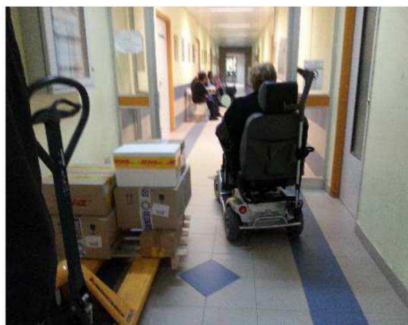
ESEMPIO DI Interferenza a rischio urto / impatto/ schiacciamento (delle estremità inferiori) fra movimentazioni merci mediante trans pallet manuale e lavoratori aziendali, utenti normodotati e disabili.
