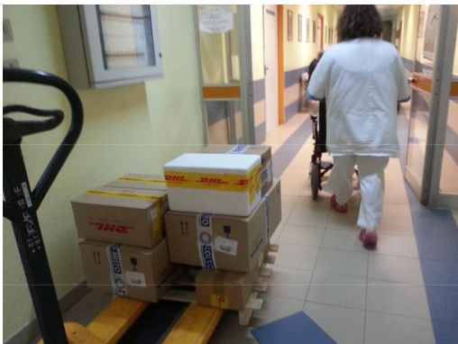
ESEMPIO DI Interferenza a rischio urto / impatto/ schiacciamento (delle estremità inferiori) fra movimentazioni merci mediante trans pallet manuale e lavoratori aziendali, utenti normodotati e disabili.
